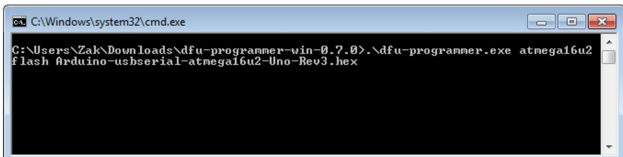
Enfin copiez et collez (en faisant clic droit sur le terminal) la commande « `.\dfu-programmer.exe atmega16u2 flash Arduino-usbserial-atmega16u2-Uno-Rev3.hex` »
