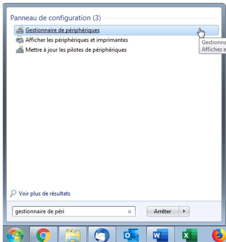
Si une ligne avec un panneau attention jaune apparaît, cela veut dire que le pilote n'est pas installé. Sinon vous pouvez passer directement à la section « [Installation du firmware](#) ».
